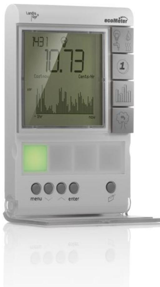
Информационный дисплей абонента P350 ecoMeter отображает данные энергопотребления, полученные с интеллектуальных приборов учёта энергоресурсов по беспроводному коммуникационному каналу стандарта M-Bus.
